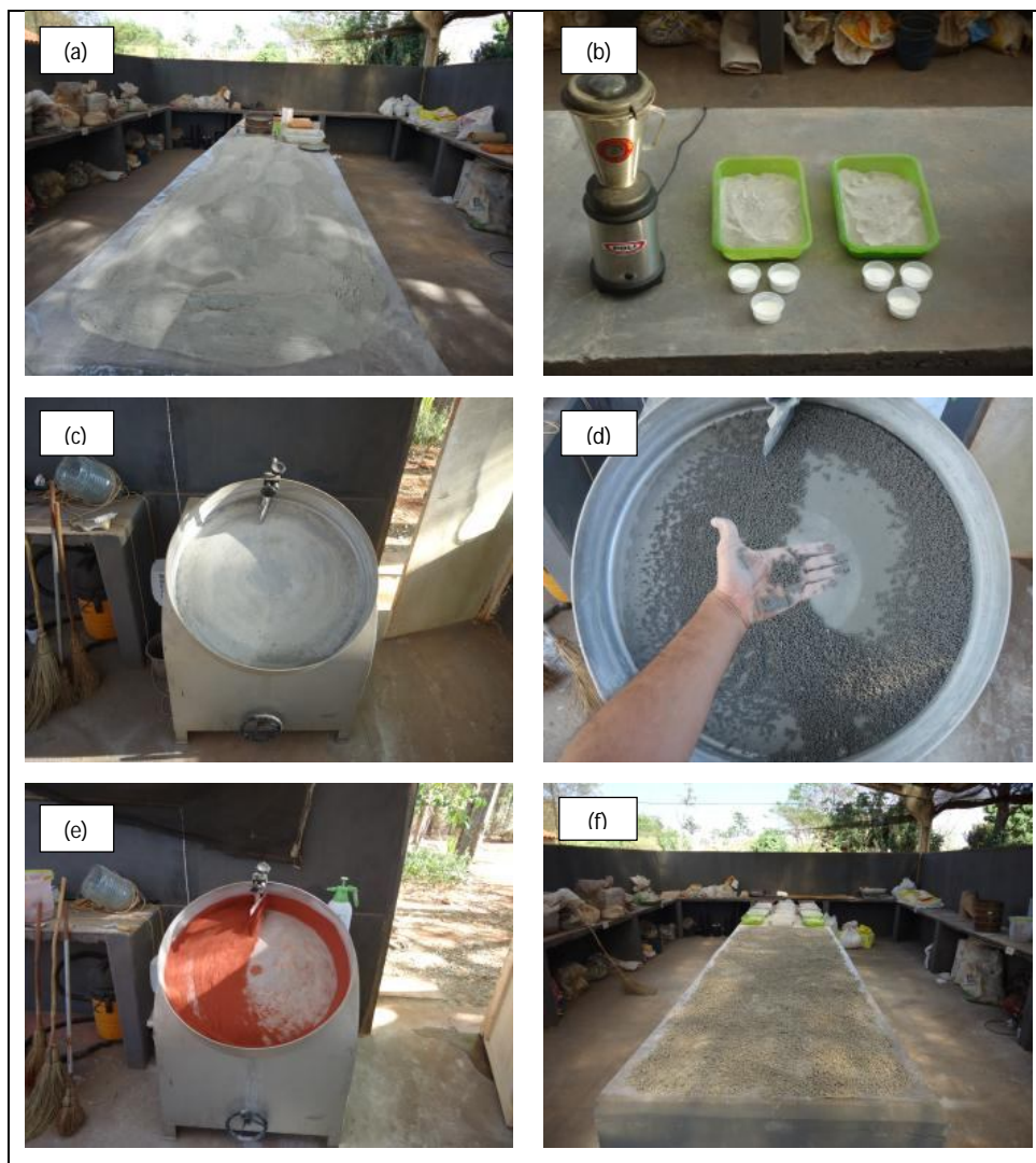
Figura 4. Procedimentos de granulação na Embrapa Solos - Unidade de Rio Verde, GO. (a) SSP-60 em pó; (b) adição e mistura de fosfato monocalcico; (c) granulador do tipo prato; (d) granulação do SSP-70; (e) granulação do SSP-50; (f) secagem do SSP-70.
