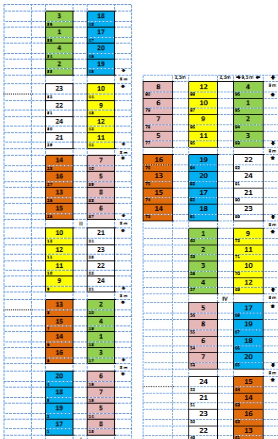
Figura 3. Arranjo das unidades experimentais em campo indicando as dimensões das subparcelas, espaço entre parcelas (para tráfego/manobra de máquinas) e entre blocos. Nota-se, nesta figura, que os blocos foram colocados um ao lado do outro para facilitar a visualização. A disposição correta desses blocos no campo é mostrada na Figura 2.
